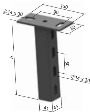
Предназначен для одностороннего крепления держателя с использованием гайки РМ 41 М 10 и болта с шестигранной головкой S 10X20. При двухсторонней установке держатели крепятся с помощью болтов S 10X70, гаек М 10 и шайб РD 10.
