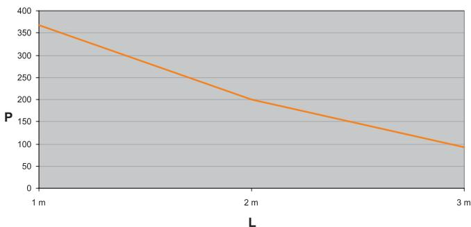
На графике показана максимально допустимая равномерно распределенная нагрузка лотка в зависимости от расстояния между опорами.
