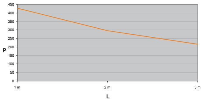
На графике показана максимально допустимая равномерно распределенная нагрузка лотка в зависимости от расстояния между опорами.
