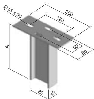
Предназначен для одностороннего и двухстороннего крепления быстрозажимных держателей DRT. Используется в качестве держателя на потолок или пол. OKSPT - концевое уплотнение из PVC.
