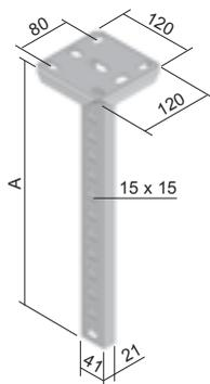
Предназначен для одностороннего крепления держателей DS и DT с использованием гайки PM 41 M 10 (PMP 41 M 10) и болта с шестигранной головкой S 10X20.
